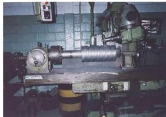
TORNILLOS IMPULSORES IZQ. Y DER. PARA BOMBA WORTHINTONG EN ACERO NODULAR – ECOPETROL S.A-
