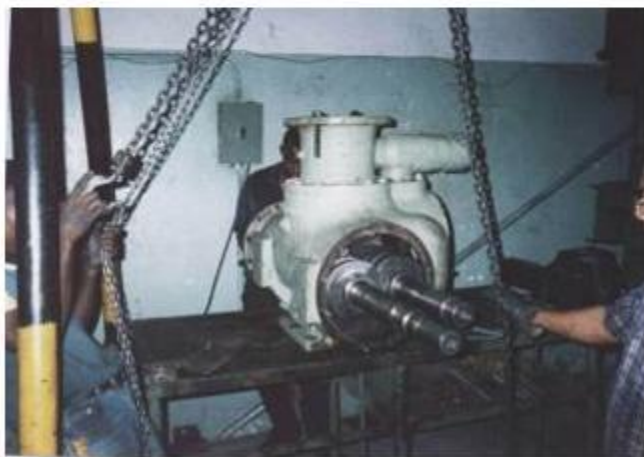
TORNILLOS IMPULSORES IZQ. Y DER. PARA BOMBA WORTHINTONG EN ACERO NODULAR – ECOPETROL S.A-
