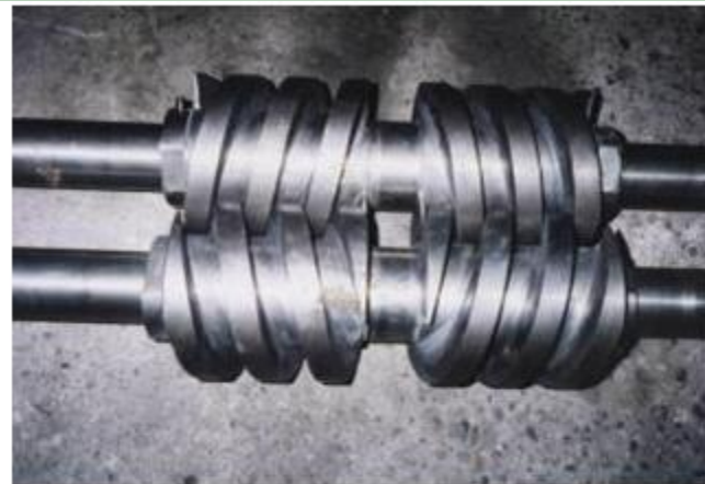
TORNILLOS IMPULSORES IZQ. Y DER. PARA BOMBA WORTHINTONG EN ACERO NODULAR – ECOPETROL S.A-
