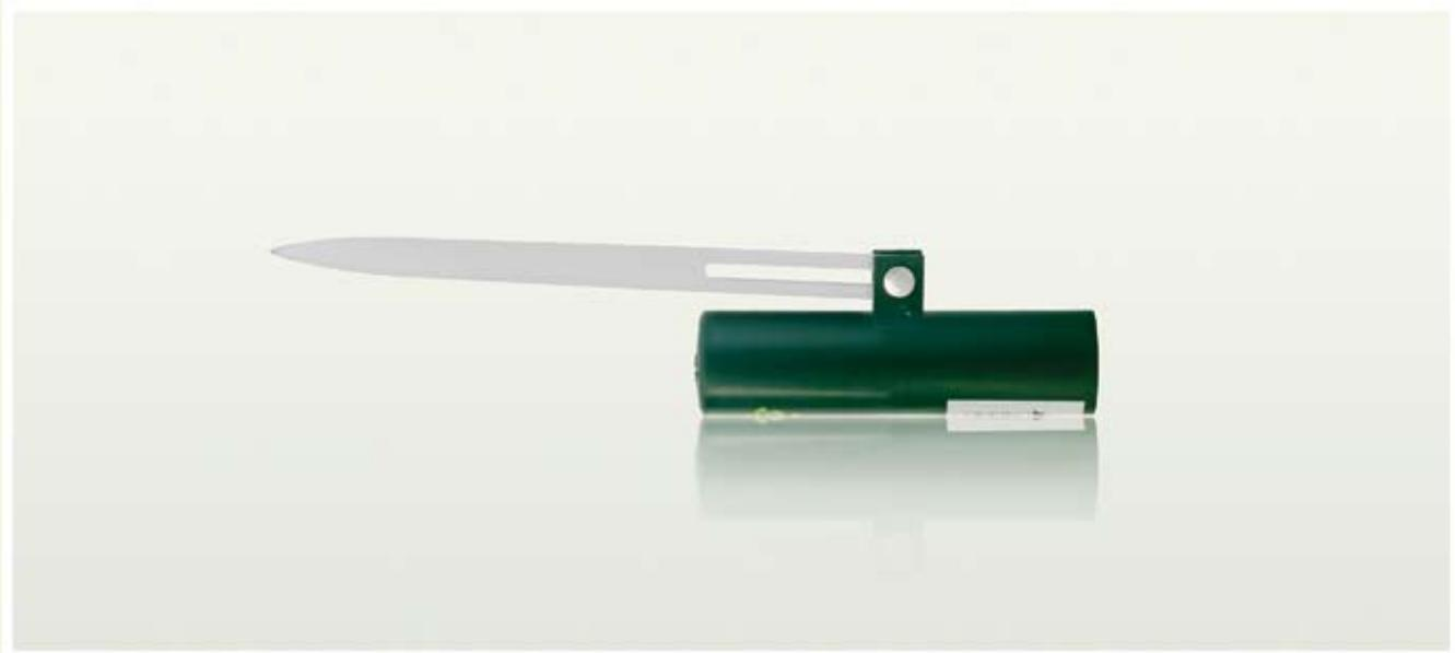
Explosivo contenido en un envase tubular, que en el frente tiene un cono metálico que garantiza el efecto Monroe y en la parte trasera cuenta con un dispositivo que funciona como centrador y seguro del detonador.
