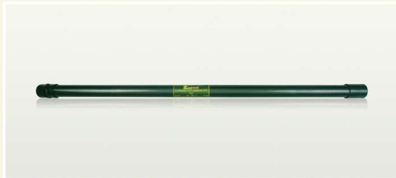
Artefacto compuesto por un tubo de PVC de 1,5 m de longitud y 5 cm de diámetro, que en su interior almacena una carga de TNT y es iniciado con un multiplicador de pentolita. En uno de sus extremos lleva un acople hembra y en el otro un adaptador macho que le permite un ensamblaje de varios tubos para generar la longitud de la brecha deseada.
