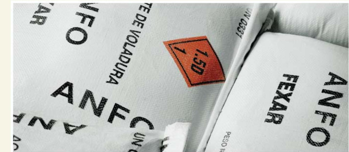
El ANFO es un agente de voladura conformado por una mezcla de nitrato de amonio y ACPM sensible a la iniciación por un multiplicador Pentofex. Es muy seguro durante su manipulación y uso. Permite ser cargado en forma manual o neumática en los barrenos.
