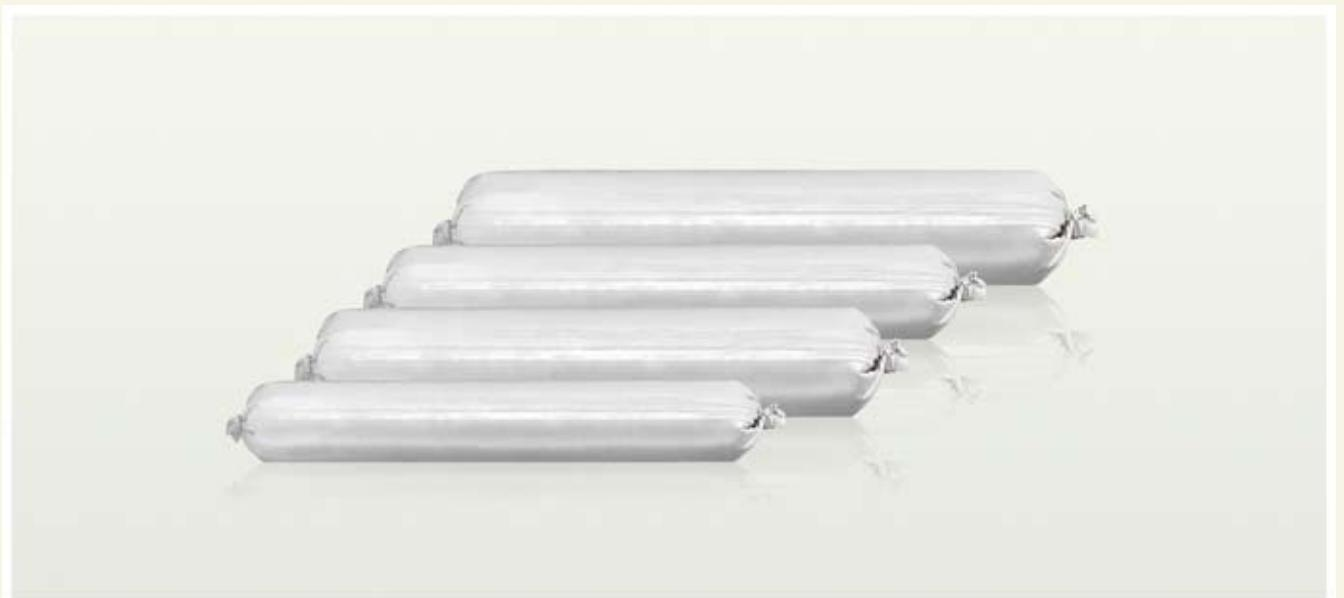
El Indugel AV 800 es un agente de voladura tipo hidrogel que requiere un multiplicador Pentofex para su iniciación. Es un explosivo, denso, fácilmente sumergible en agua y con alta energía específica. Presenta gran seguridad en su manejo debido a su baja sensibilidad al roce y al impacto. No contiene nitroglicerina por lo cual no produce dolor de cabeza durante su manipulación, almacenamiento, empleo.
