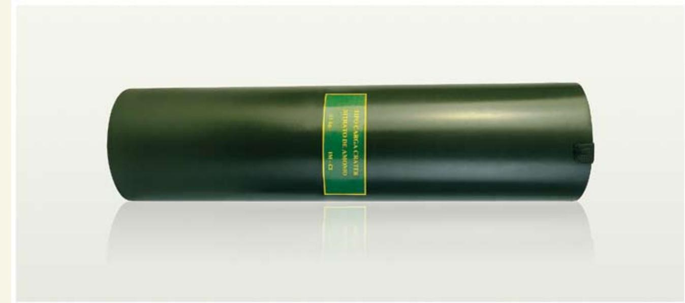
Conformada por un tubo de PVC de 6" contenido en su interior cargas de ANFO distribuidas en dos bolsas, las cuales a su vez están separadas en la parte central por un multiplicador de pentolita, atravesando radialmente el cuerpo cilíndrico.
