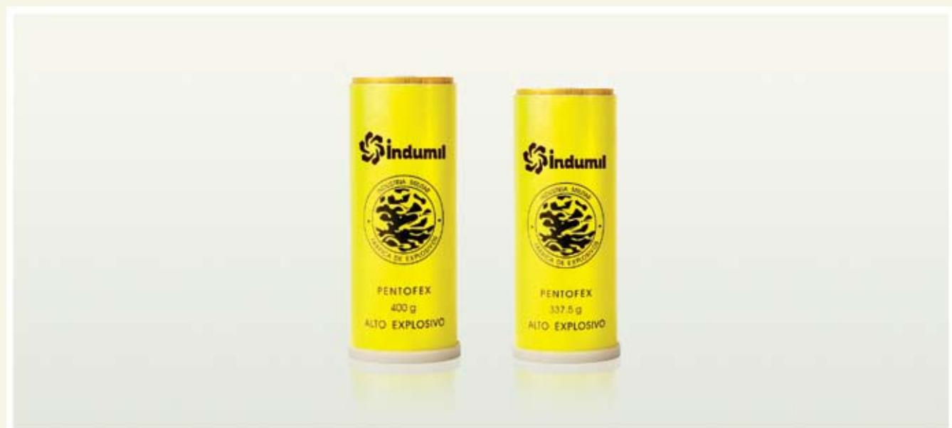
Pentofex es un multiplicador a base de pentolita sensible al detonador común número 8 con alta densidad, velocidad y presión de detonación. Se desempeña como iniciador de fondo de barreno de agentes de voladura como son las emulsiones, el ANFO y mezclas de emulsión/ANFO. Los multiplicadores Pentofex son formulados a partir de la mezcla de pentrita (PETN) de la más alta calidad y otro alto explosivo que asegura confiabilidad, consistencia y durabilidad en todos los ambientes de voladura.
