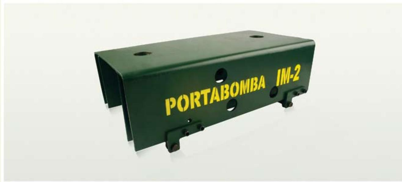
Dispositivo diseñado teniendo en cuenta las necesidades de la Fuerza Aérea de poder portar un mayor número de bombas por punto duro y de esta forma incrementar la capacidad de combate de las aeronaves. Está siendo diseñado para aviones OV-10 y el cargue de 4 bombas de 125 lb, por cada portabombas Indumil.
