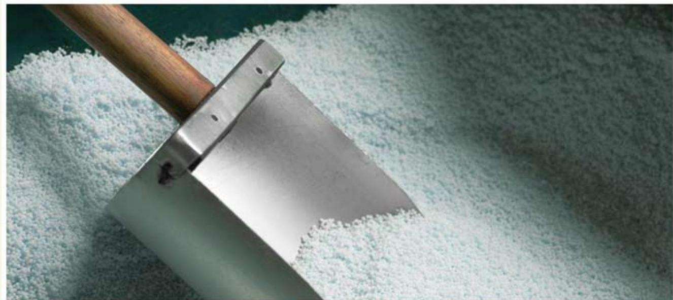
El ANFO puede cargarse directamente de las bolsas al barreno y puede cargarse neumáticamente con equipo de carga neumático debidamente aprobado.
