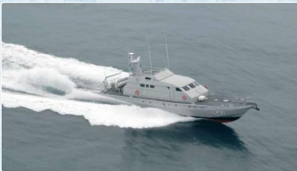
O Aviso de Patrulha classe "MARLIM" foi desenvolvido para atender às necessidades da Marinha do Brasil no âmbito das operações de policiamento naval. A embarcação é construída em alumínio, sendo projetada para patrulha rápida em áreas portuárias e costeiras. Uma metralhadora leve e removível de 7,62 mm foi posicionada na proa, embora a estrutura e estabilidade da embarcação permitam a instalação
