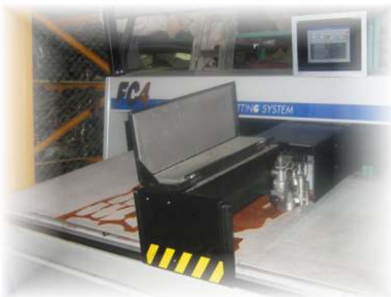
CORTE CON MAQUINA TESEO Fc4 CNC POR SOFTWARE NAXOS
