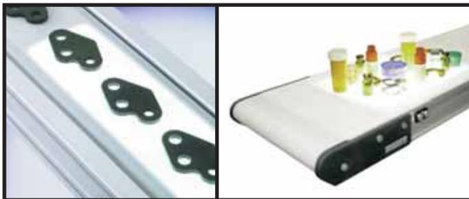
El diseño de la estructura mecánica esta basado en las normas de la FDA (US Foods and Drugs Administration) para la selección de los materiales y diseño de los elementos usados en la banda transportadora.
